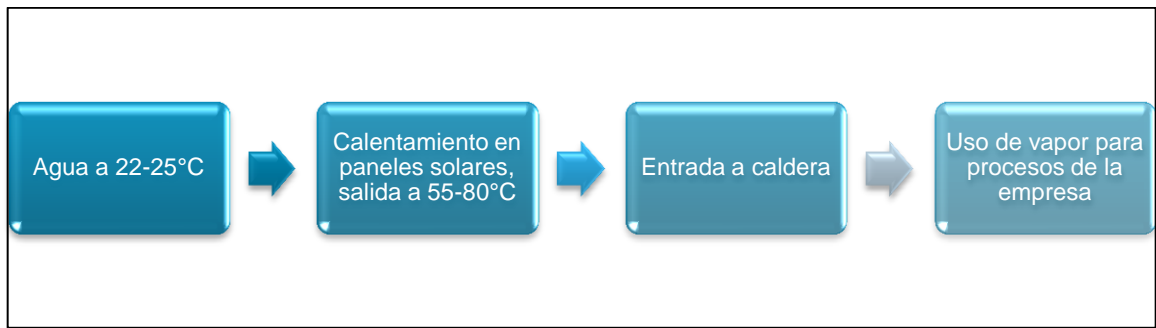
Figura 4-27 Diagrama de proceso de calentamiento de agua
