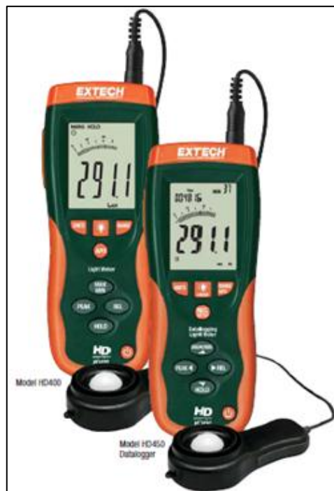
Figura 7-4 Luxómetro empleado para la medición de intensidad luminosa HSRA, 27/04/2011
