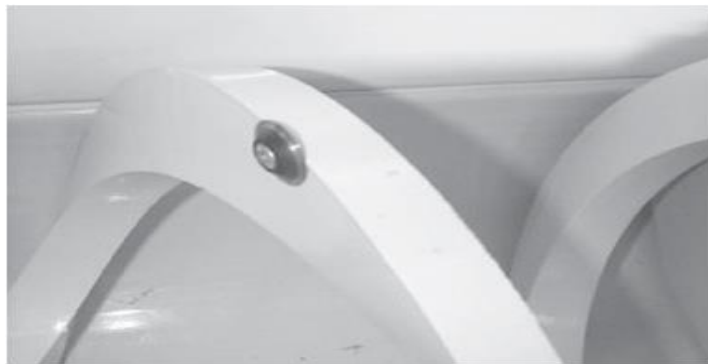
Figura B.3.3. Tornillo de cuchillas que rompen los sacos de cemento. Tomado de Wangroup (2001).
