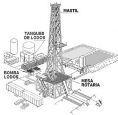
Figura 0.8. Mástil y equipo de perforación. Tomado de C.S.R.G. (2015)
