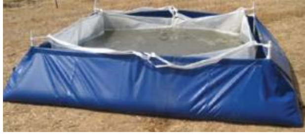
Figura B.3.7. Bolsas filtrantes de efluentes con cemento producto del lavado de maquinaria y equipo de cementación. Tomado de la Environmental Protection Agency. (2015).
