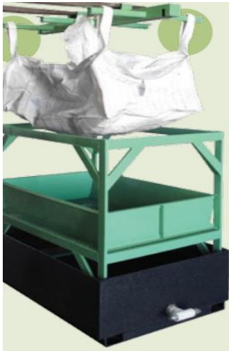
Figura B.3.8. Instalación de bolsas filtrantes. Tomado de la Environmental Protection Agency. (2015).
