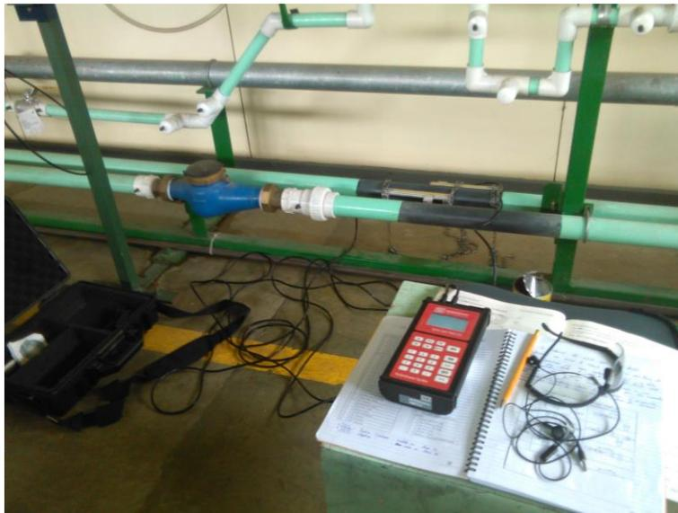
**Figura 8. Medidor de flujo ultrasónico Innova Sonic 210i series instalado en la PHICO del CIVCO.**
