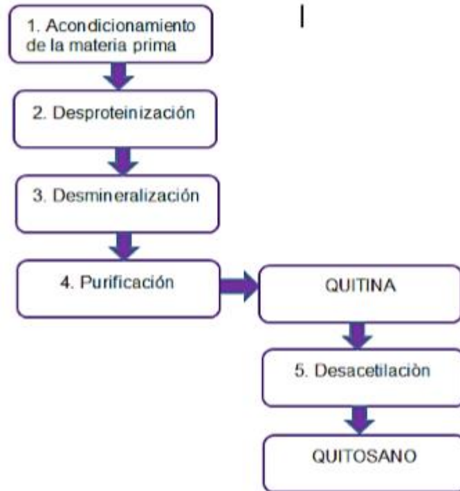
Figura 2. 2. Diagrama de la obtención de la quitina y el quitosano Fuente: Tafur & Quebedo, 2014.
