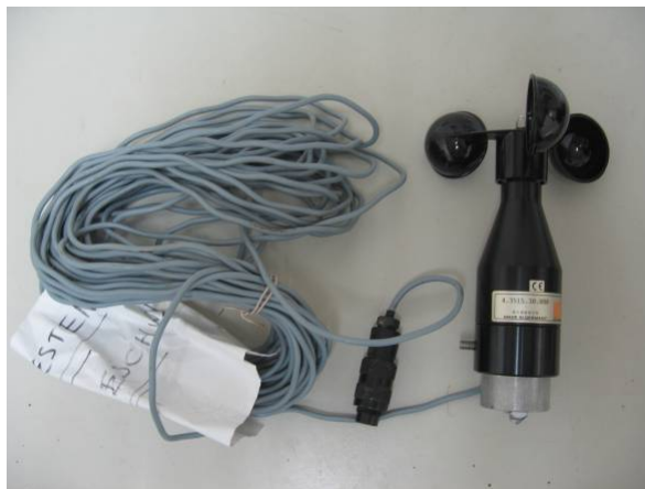
Figura A.5.1 Anemómetro de cazoletas marca Thies Clima , modelo 4.35.1530.000.
