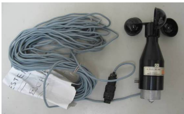
Figura 5.21 Anemómetro marca Thies Clima , modelo 4.35.15.30.000.
