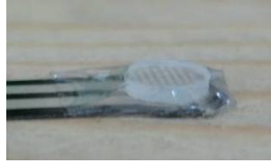
Figura 6.3 Sensor piezoresistivo FSR-149 con un disco de plástico sobre el área activa.
