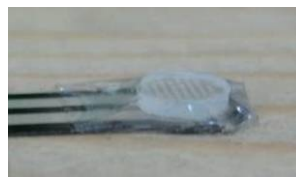
Figura 5.17 Sensor piezoresistivo FSR-149 con un disco de plástico sobre el área activa.
