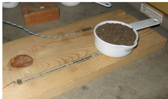
Figura 6.5 Taza con arena aplicada al sensor piezoresistivo FlexiForce .
