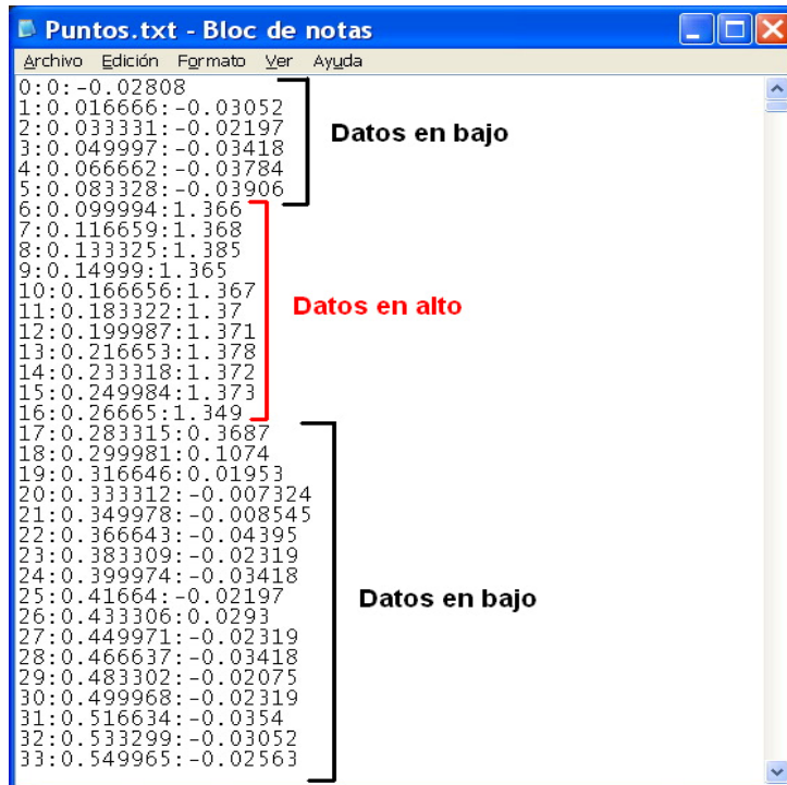
Figura A.6.2 Datos en alto y en bajo del anemómetro y obtenidos mediante el datalogger.
