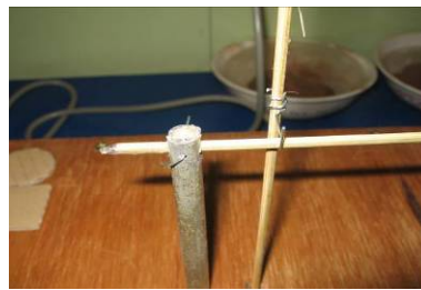
Figura 6.12 Sistema para transmitir la fuerza del viento a la balanza.
