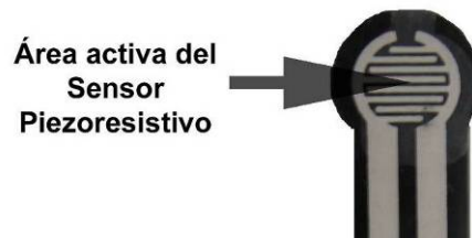
Figura 5.7 Área activa del sensor piezoresistivo.
