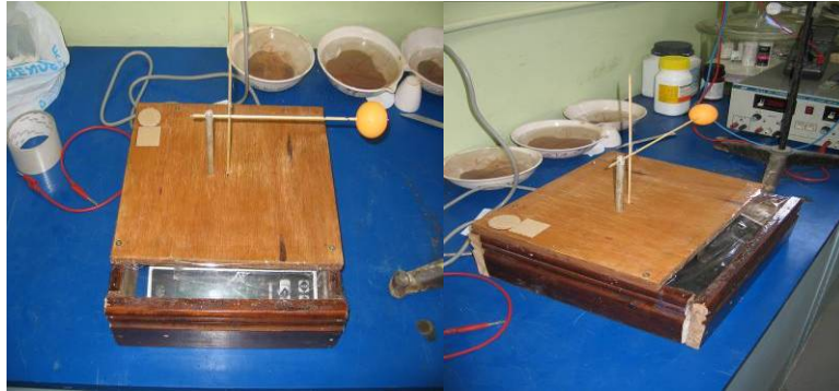
Figura 6.10 Sistema mecánico para captar la fuerza del viento.
