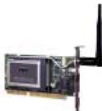
Figura 4.10 Adaptador ISA340 de la serie Cisco Aironet 340.
