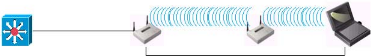
Figura 4.16 Uso de una punto de acceso como repetidor.
