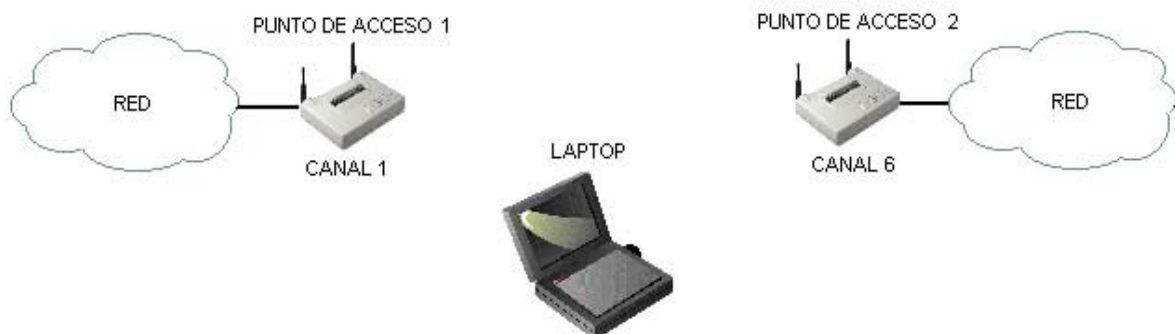
Figura 7.3 Red inalámbrica utilizada para la demostración 3 con dos puntos de acceso como raíz.
