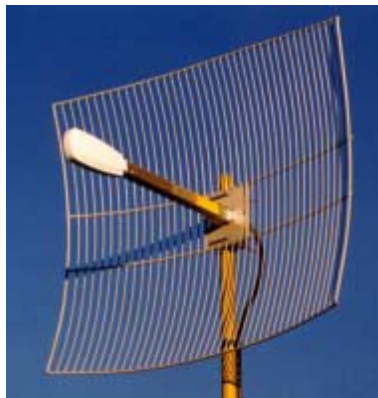
Figura 5.18 Antena parabólica de rejilla de alta directividad.
