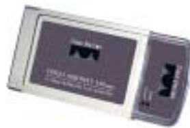
Figura 4.9 Adaptador PCM340 de la serie Cisco Aironet 340.
