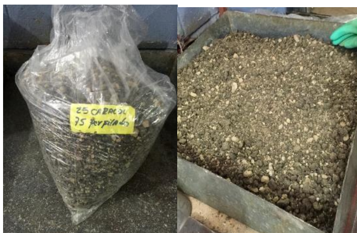
Figura 4.26. Vista de la mezcla del material de 25% MGV-02 Caracol y 75% RAP-01 Dota. Fuente: Camacho, P.
