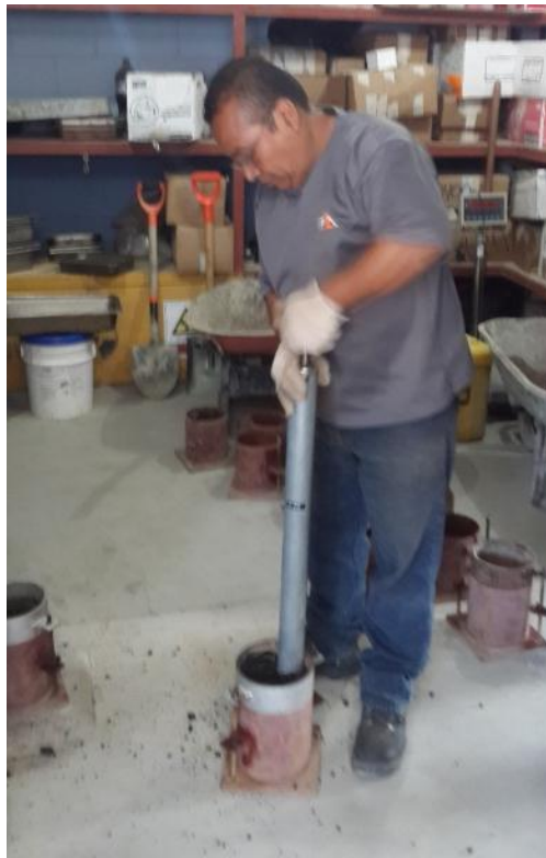
Figura 3.2. Muestra del proceso de compactación de la muestra para la Prueba de Proctor Modificado. Fuente: Camacho, P. 2016.
