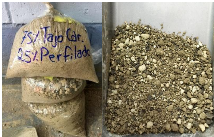
Figura 4.24. Vista de la mezcla del material de 75% MGV-02 Caracol y 25% RAP-01 Dota. Fuente: Camacho, P.
