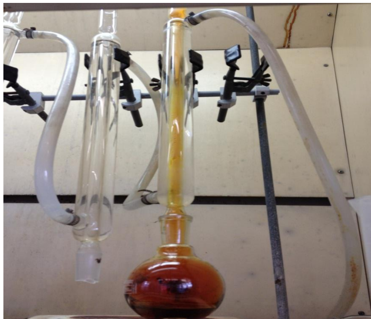
Figura 8. Reflujo de nanotubos de carbono en una mezcla de ácido sulfúrico y nítrico 3:1. Fuente: elaboración propia.
