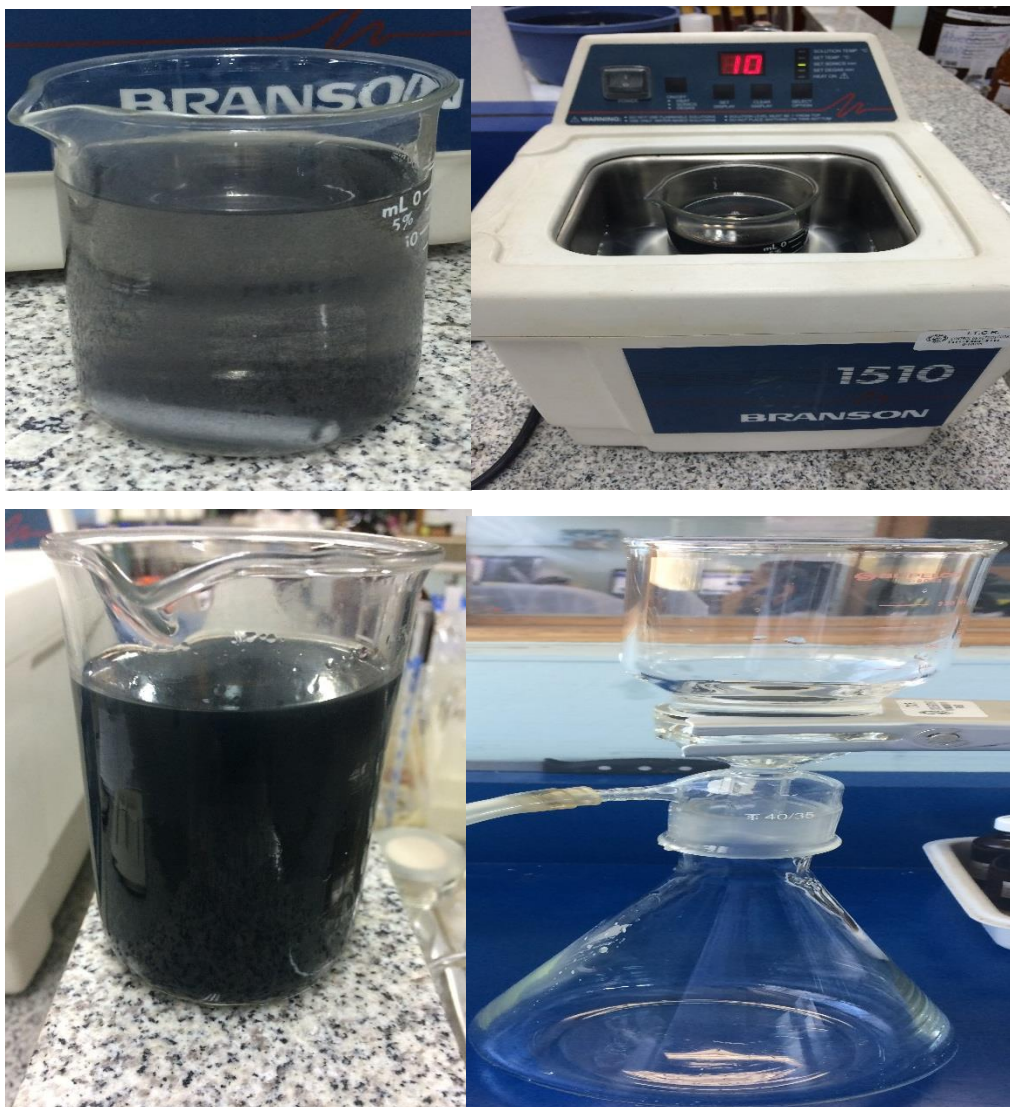
Figura 10 Proceso de elaboración de “bucky papers” a partir de nanotubos de carbono funcionalizados con grupos OH-.
