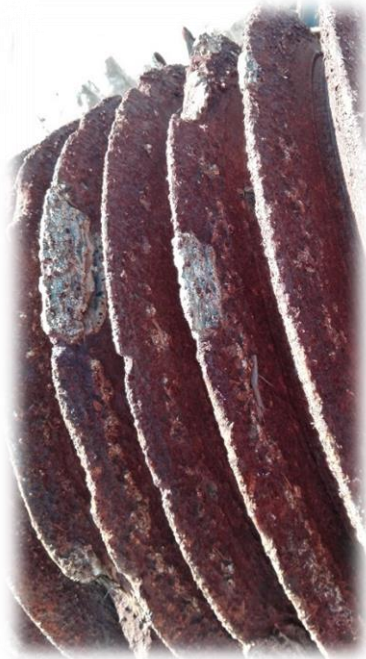
Figura 17. Reparaciones en los dientes de las mazas.
