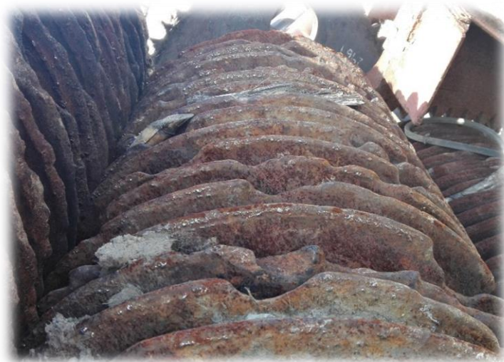
Figura 18. Condición de las mazas de molienda al finalizar la zafra del 2016.
