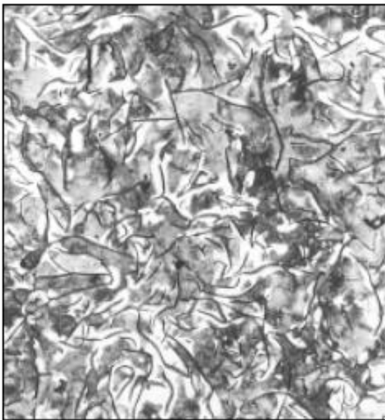
Figura 6 – Microestructura típica en el núcleo (VERSA-BAR FC-200)
