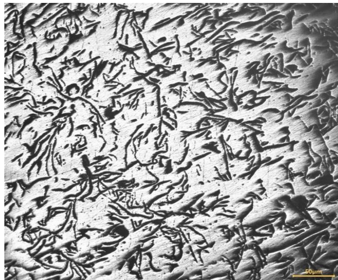
Figura 7. Metalografía a 40x sin atacar de la muestra de la superficie del material procedente de Colombia.
