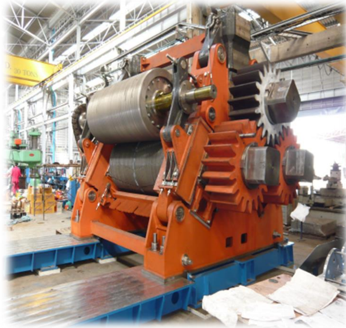
Figura 2. Molino de cuatro mazas de Allied-Tek. Fuente: Allied-Tek Engineering Co, Ltd. (2012). Allied-Tek Cane Mill . Recuperado de http://www.allied-tek.com/C_CaneMill_V5.1.pdf
