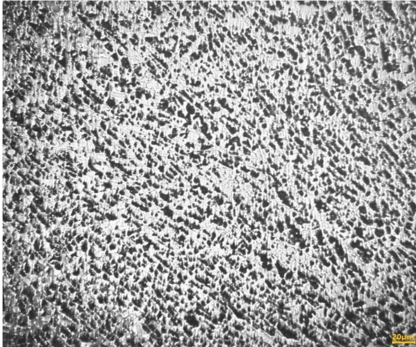
Figura 9. Metalografía a 40x sin atacar de la muestra de la superficie del material procedente de Brasil.
