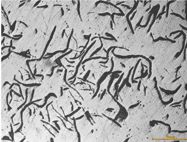
Figura 8. Metalografía a 250x sin atacar de la muestra de la superficie del material procedente de Colombia.
