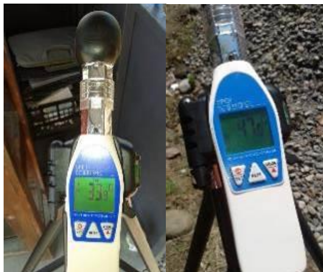
Figura 5.6. Mediciones de temperatura TG con y sin sombra (estructura metálica)
