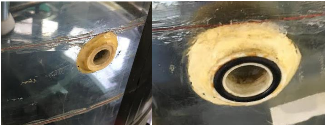
Figura 29. Entrada para inyección de gas de MEDUSA-CR.
