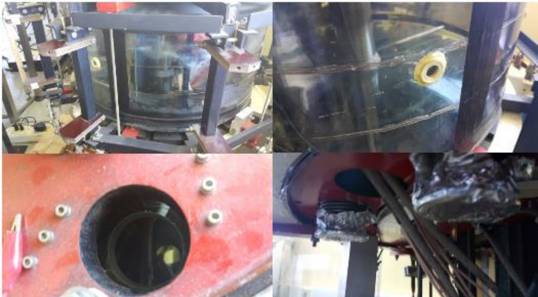
Figura 12. Fotos de la cámara de vacío del Tokamak MEDUSA-CR así como también de algunos de sus puertos.
