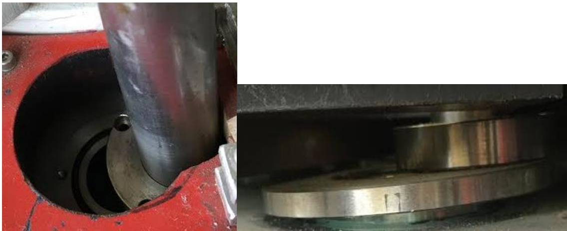
Figura 31. Acople y colocación del pasamuros de MEDUSA-CR.
