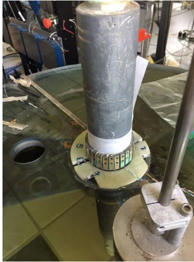
Figura 21. Procedimiento de desarme de MEDUSA-CR.
