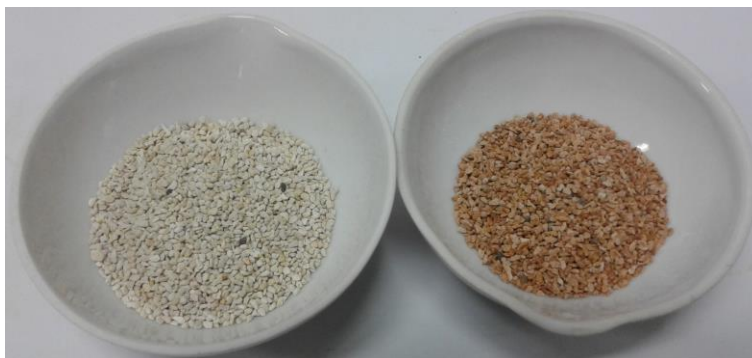
Figura 4.1. Muestras de piedra pómez cruda (a) y recubierta de hidróxido hierro (b).
