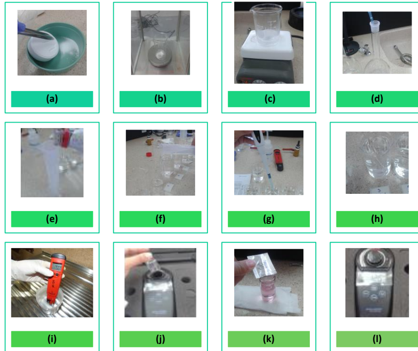
Figura 34. Procedimiento para la determinación de la curva de la demanda de cloro
