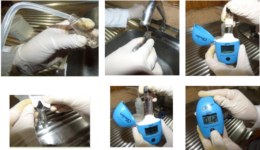
Figura 32. Medición de cloro residual libre realizada en tanques de almacenamiento y red de distribución
