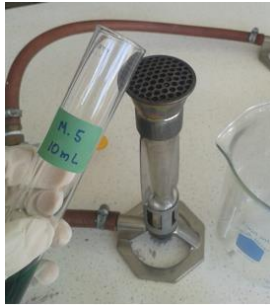
Figura 25. Técnica séptica: flameo de los tubos de ensayo
