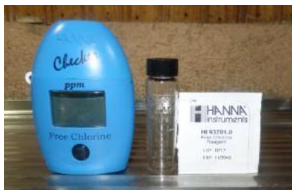
Figura 60. Instrumentos requeridos para medir el cloro residual: medidor de cloro, recipiente de medición y reactivo de DPD (de izquierda a derecha)
