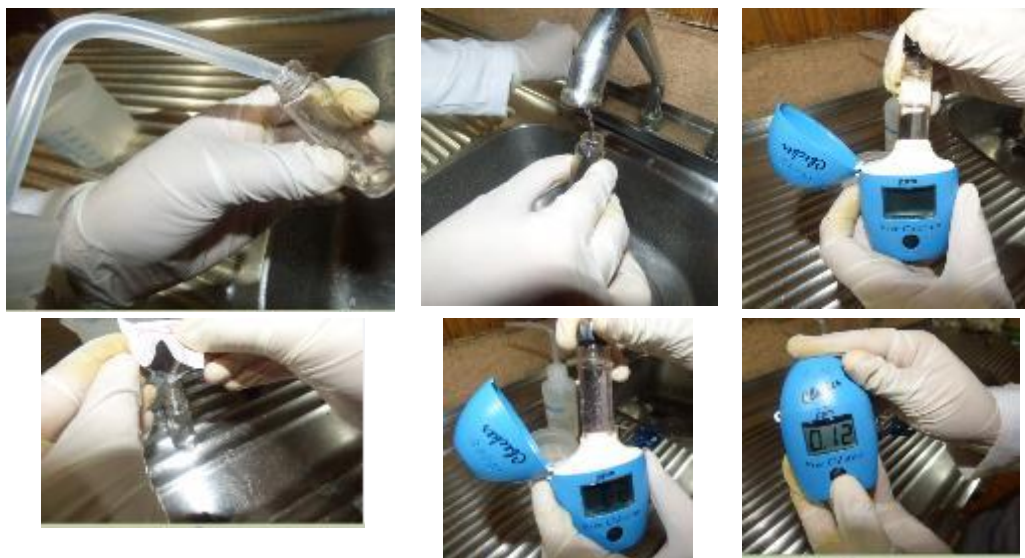
Figura 62. Medición de cloro residual libre realizada en tanques de almacenamiento y red de distribución
