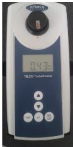
Figura 67. Turbidímetro portátil marca Orbeco-Hellige modelo TB200
