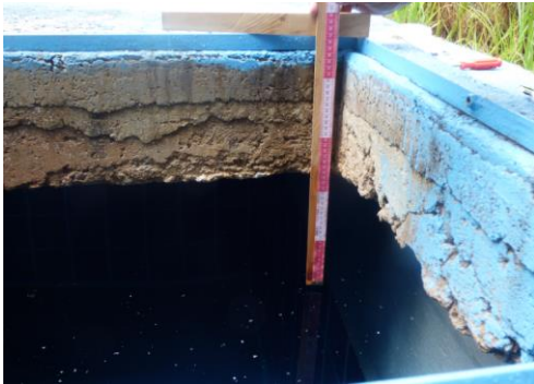
Instrumento de medición utilizado para realizar el aforo (al cerrar todas las válvulas de salida se inició el conteo para el aforo y determinar que altura incrementaba el nivel de agua en diversos lapsos de tiempo).
