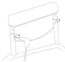
Se utiliza una llave para soltar los tornillos allen
