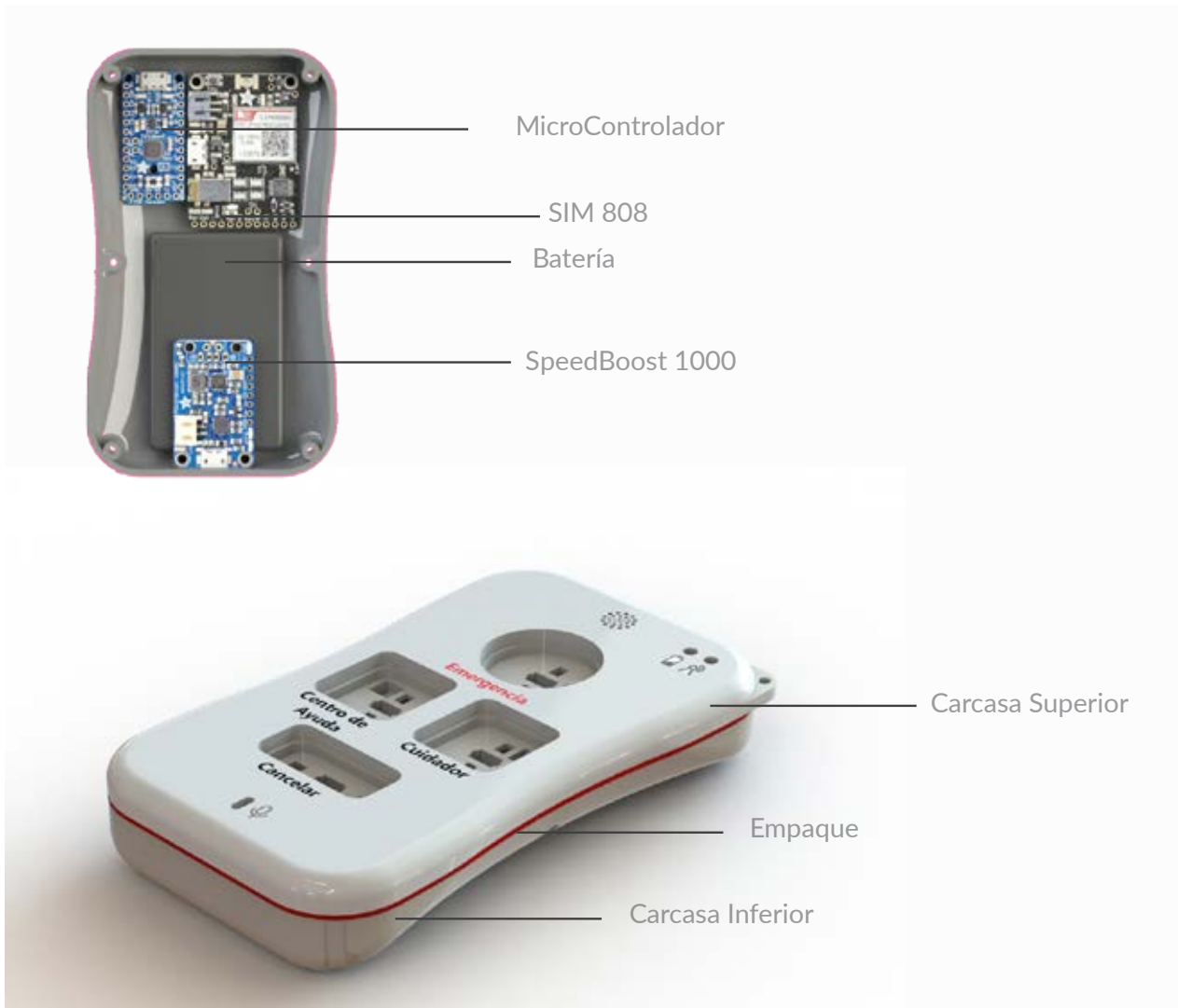
Figura 131. Subsistema de Protección
