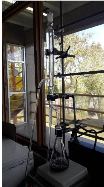
Fotografía 9.3. Equipo utilizado para la determinación de humedad.
