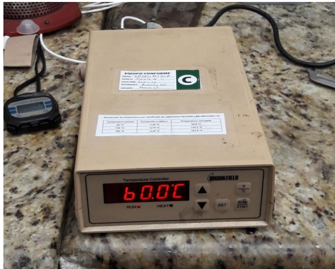
Fotografía 9.9. Controlador de temperatura utilizado para la determinación de viscosidad.
