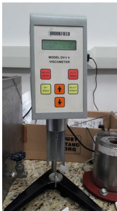
Fotografía 9.8. Viscosímetro utilizado para la determinación de viscosidad.
