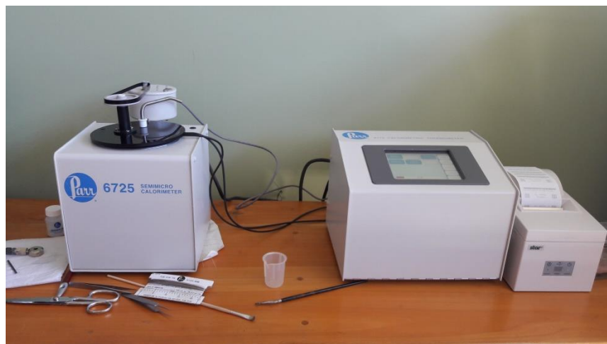
Fotografía 9.4. Calorímetro de combustión compacto y termómetro calorimétrico utilizados para la determinación de poder calorífico.
