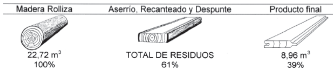
Figura 2. Diagrama del procesamiento industrial primario para madera de Gmelina arborea . Raleo realizado a los 8 años Río Grande, Paquera, enero del 2003
