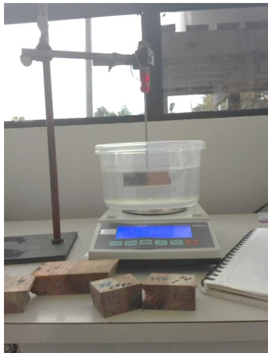
Figura 11. Determinación del volumen mediante el Principio de Arquímedes.
