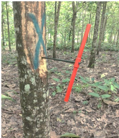
Figura 9. Obtención del tarugo de madera de T. grandis con barreno Pressler.
