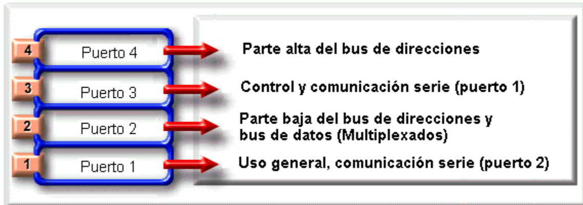
Figura 4.1 Descripción de la función de los puertos del DS80C320
