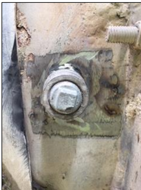
Figura 31. Tomas de medición para tubo pitot instalada a la entrada del ventilador.
