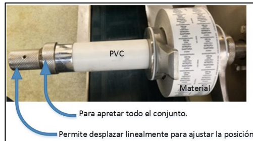
Figura 15 Sistema de ajuste de rollos de material encelofanado.
