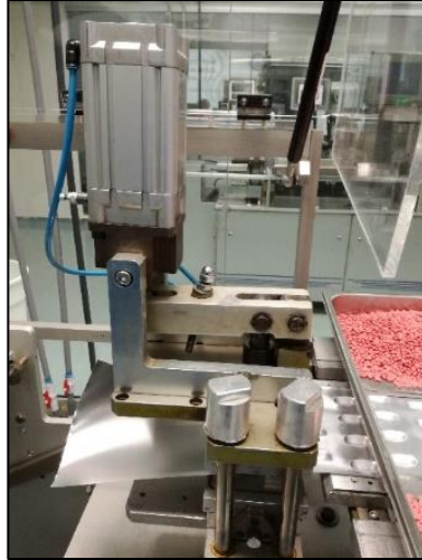
Figura 22. Estación de Formado.
