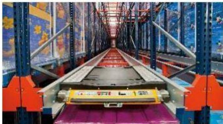
*Figura 3. Sistema de almacenamiento Radio Shuttle.*
