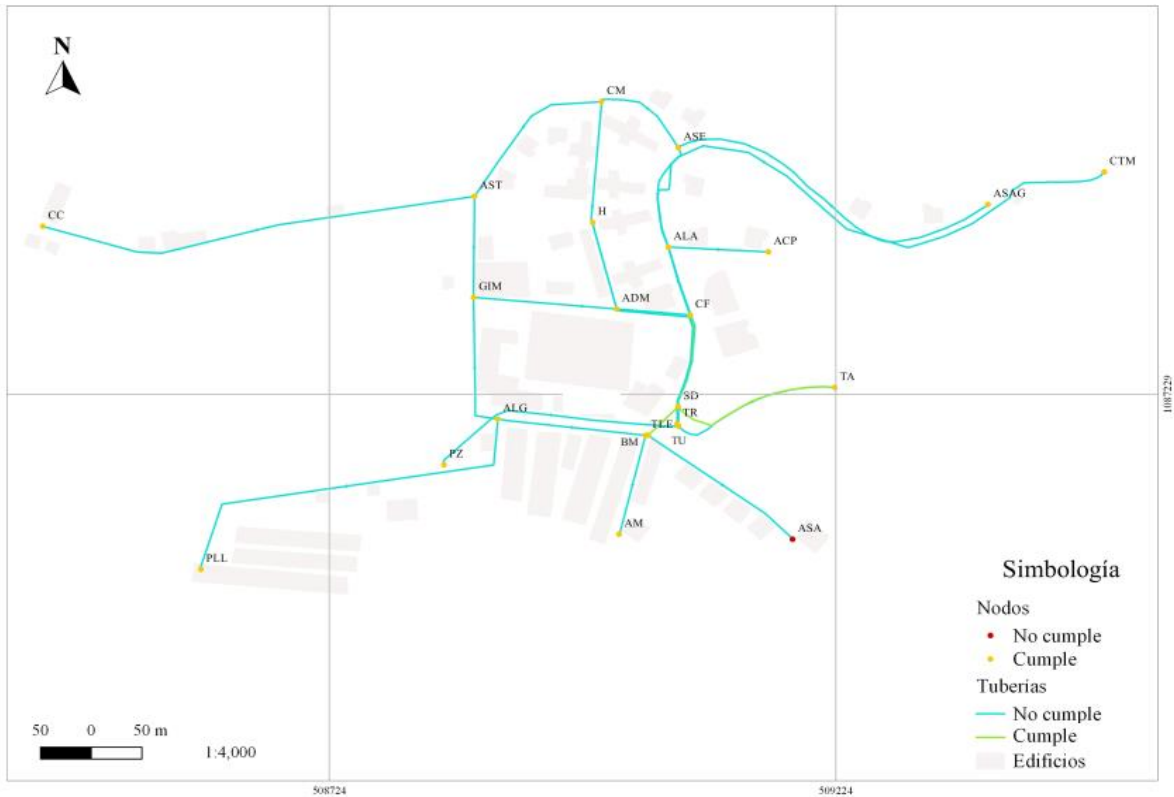
Figura 4.23 Mapa de cumplimiento de velocidad en tuberías y presión en nodos del modelo
