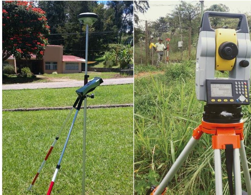
Figura A.1.1 Levantamiento topográfico mediante el uso del GPS y la estación total en CDN
