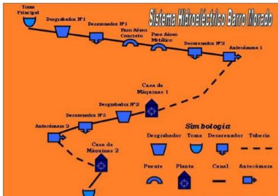
Figura 2. Proceso Productivo de generación de energía eléctrica en Barro Morado I y II
