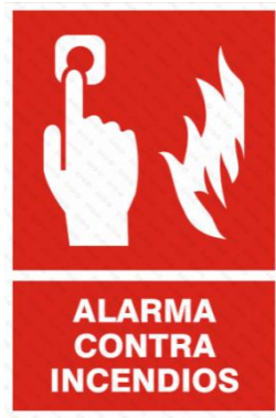
Figura V-20. Rotulación de la estación de alarma contra incendios. Fuente: Notifier, 2016.
