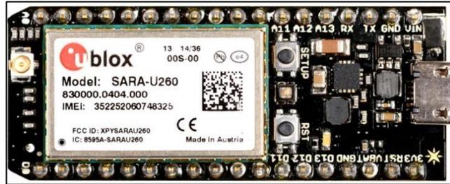
Figura 5.3. Electron 3G. Fuente: Particle [11].
