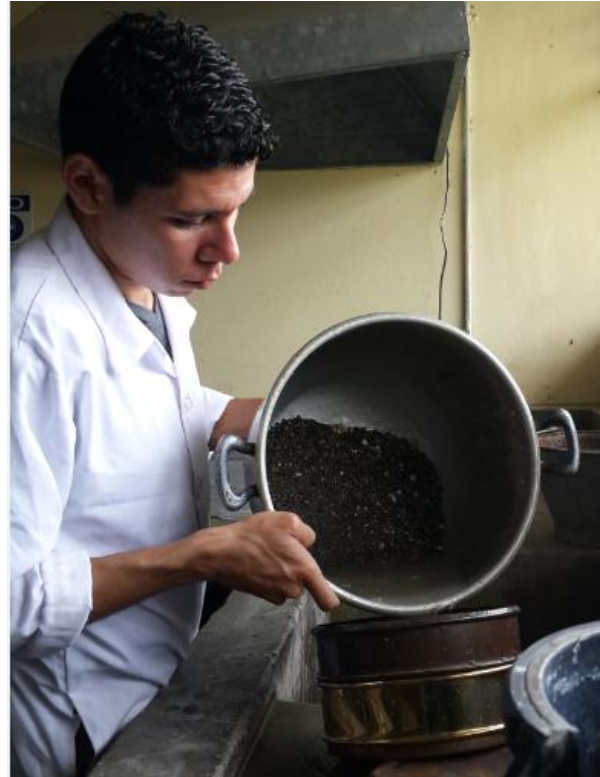
Figura 8. Lavado de la arena por el tamiz No 200.
