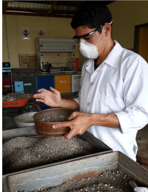
Figura 9. Tamizado de forma manual para determinar la distribución granulométrica.
