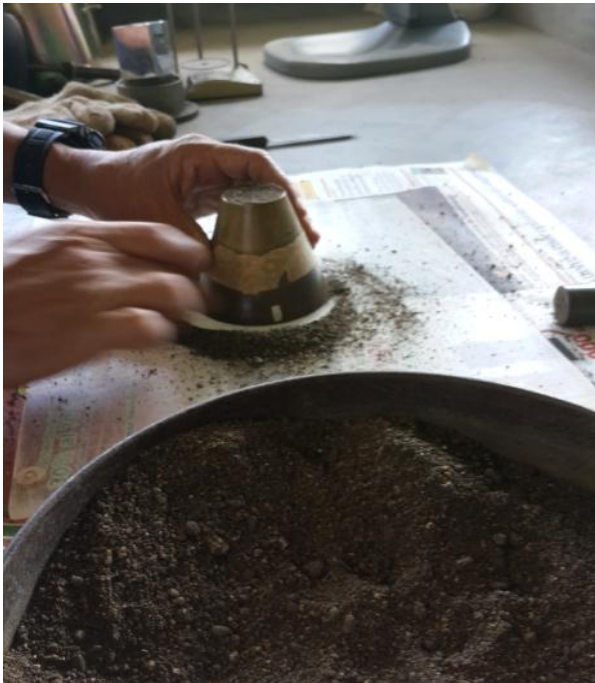
Figura 11. Eliminación del material excedente en la lámina acrílica.
