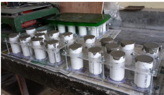
Figura 15. Mezcla finalizada de microconcreto
