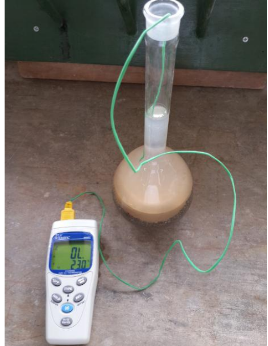
Figura 12. Medición de la temperatura del agua dentro del picnómetro.
