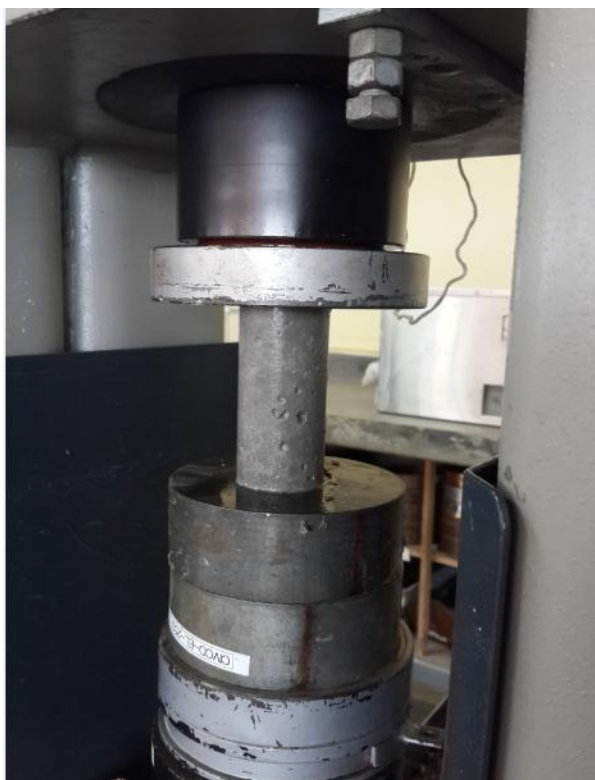
Figura 17. Colocación y falla de cilindro de muestra en la máquina de ensayo.
