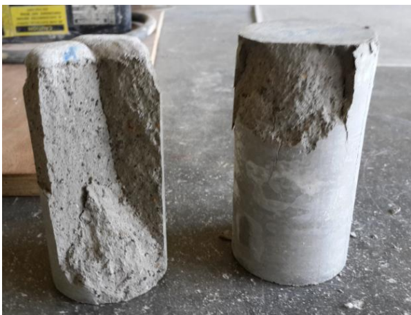
Figura 18. Cilindros fallados haciendo uso de la almohadilla de neopreno (cilindro de la izquierda) y sin usar almohadilla de neopreno (cilindro de la derecha).
