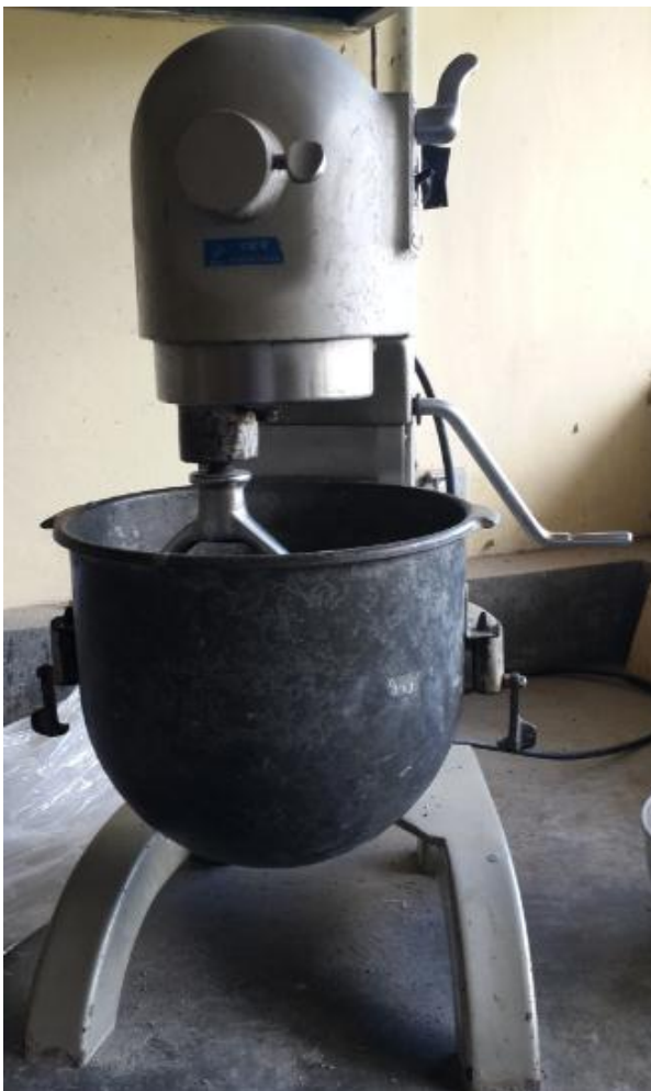
Figura 14. Batidora industrial utilizada para la fabricación del microconcreto.
