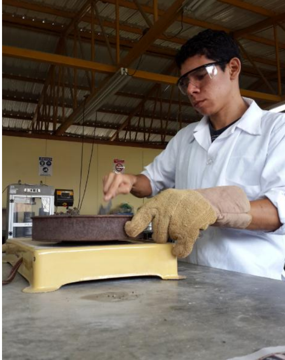
Figura 10. Proceso de eliminación del exceso de humedad en la cocina eléctrica.
