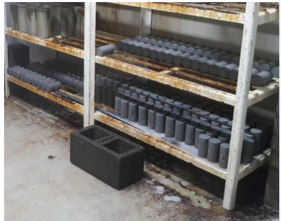
Figura 16. Cilindros de microconcreto dentro de la cámara húmeda
