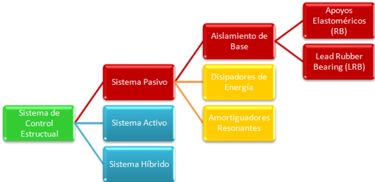
Figura 8. Tipos de Sistema de Control Estructural. Fuente: Elaboración Propia. Realizado mediante Microsoft Excel
