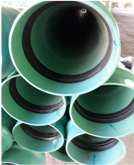
Figura 22. Tubería con campana hidráulica. Fuente: propia
