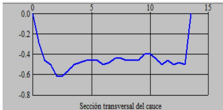
Figura 16. Sección Transversal del cauce, río Caracol.
