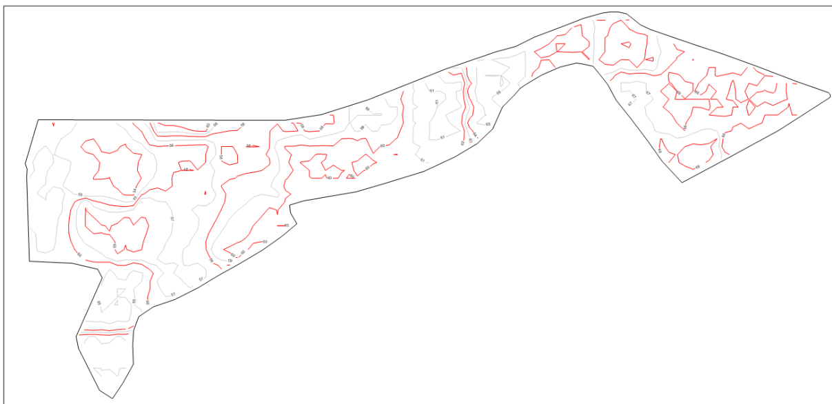
Figura 15. Plano curvas de nivel del levantamiento topográfico
