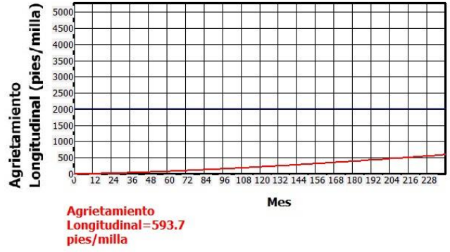
Figura 31. Agrietamiento longitudinal en la vida útil del pavimento Fuente: Interfaz gráfica para el diseño mecánico-empírico de pavimentos en Costa Rica CR-ME
