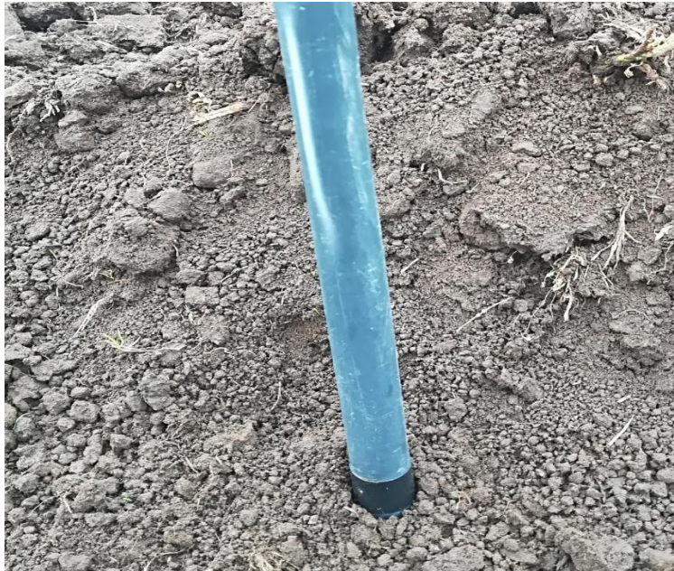
Figura 35. Marca de referencia en los tubos colocados en campo.
