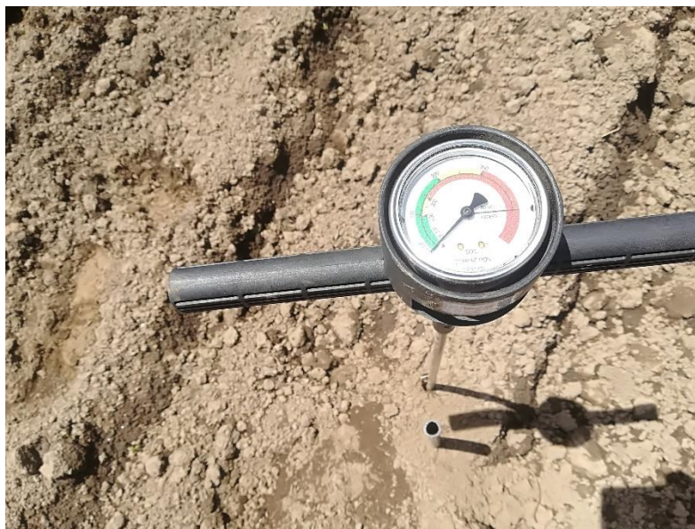
Figura 18. Utilización de penetrómetro en campo.
