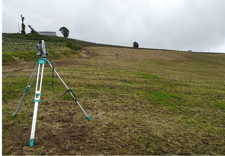
Figura 14. Levantamiento topográfico con Estación Total.
