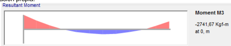
Figura 38. Marco de concreto de 2D de la Pila 1 con el asentamiento de la columna central en conjunto con la rotación del cimiento izquierdo. Fuente: Elaboración propia.
