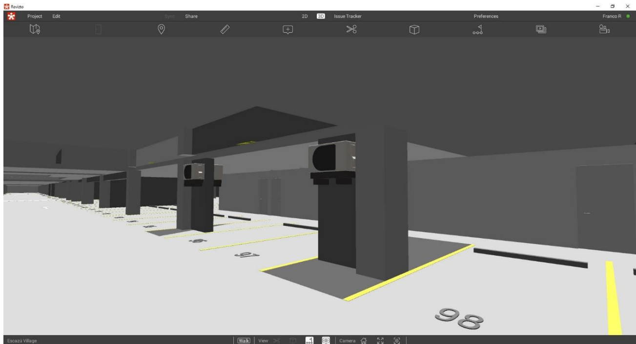
Figura 10. Condensadores de aire acondicionado ubicados en el nivel S100 del modelo BIM electromecánico Fuente: Elaboración propia con base en Autodesk Revit, 2017
