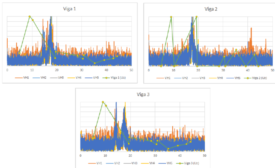
Figura 28. Contenido frecuencial obtenido de datos in situ versus modelo estructural.
