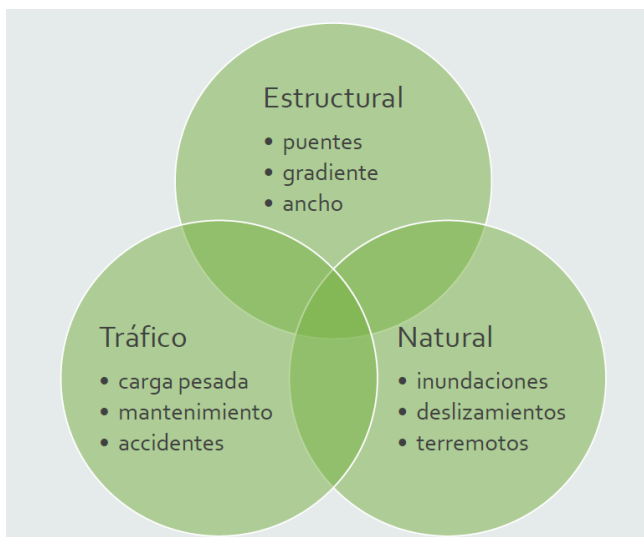
Figura 31. Vulnerabilidades en infraestructura de transporte. (Husdal, 2005)
