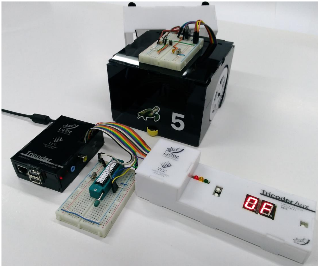
Figura 8 Robot Krotic en el proceso de grabación de E2PROM
